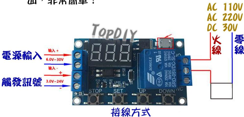
繼電器輸出乾接點，控制一條線路的通斷
