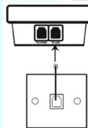
3. 將電話線插入Call Blocker的LINE端口。
